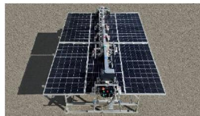
太陽光パネル清掃ロボット (Type2W)
