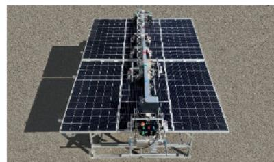
太陽光パネル清掃ロボット (Type2W)
