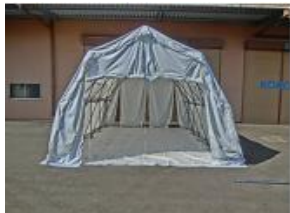
フレーム構造が分かるように一部を開けた状態のテント この状態まで2名90秒で可能、D4.1×W4.9×H2.9m、87kg
