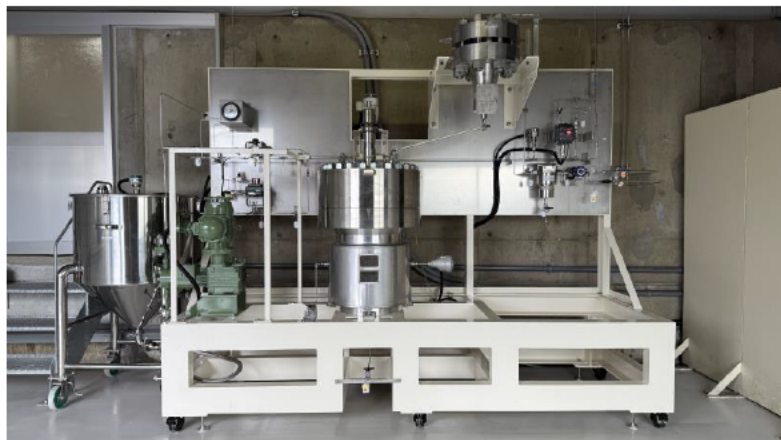
連続式水素＋炭酸ガス製造装置
