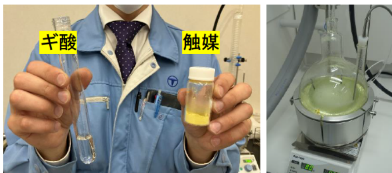
ギ酸由来の水素＋炭酸ガス製造実験
