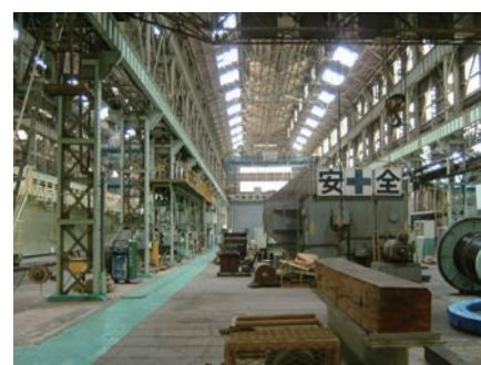
▲建屋の採光板を更新し、照明の電気使用量を大幅削減
