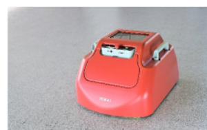
墨出しロボット
